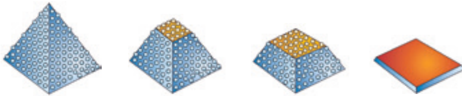
Abschleifverhalten der Pyramidenstruktur
